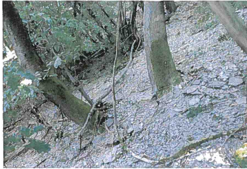
Detailfoto aus Abschnitt B, Bäume zeigen Säbelwuchs und hangseitige Schuttkegel, das Schuttmaterial besteht aus plattigen bzw. scheibenförmigen Blöcken und Steinen mit Kantenlängen bis maximal 1,0 x 0,6 x 0,4m.
