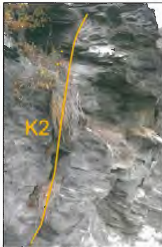
Detailfoto am Messpunkt 5. K2 tritt böschungsbildend auf.
