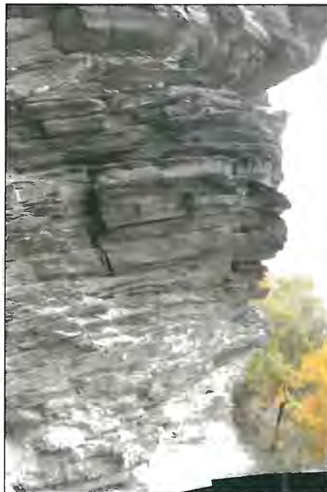
Detailfoto am Messpunkt 13, Schichthöhle mit Überhang, K1 verläuft böschungsparell.
