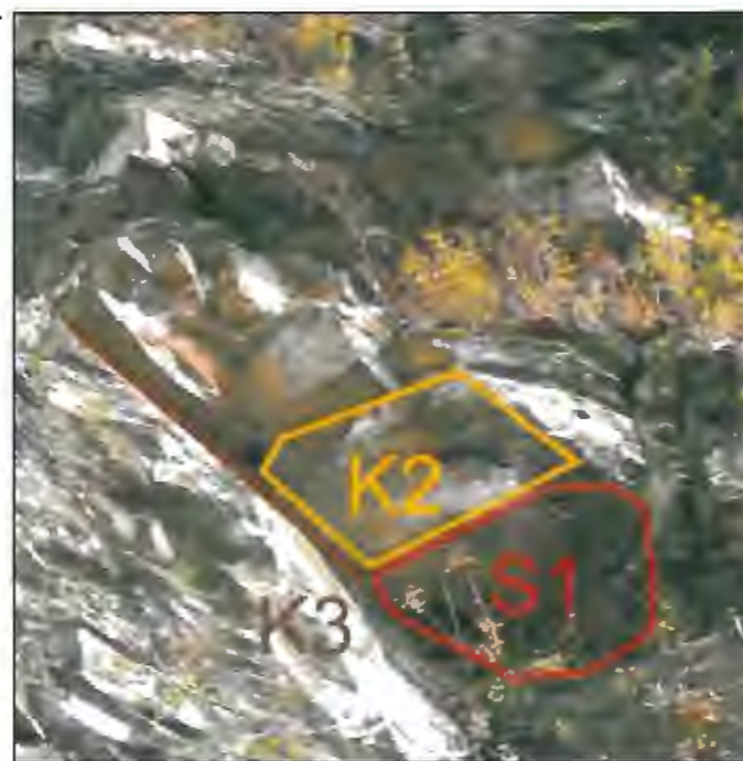
Detailfoto am Messpunkt 2. Block wird von K3 hinterschnitten und von S1 unterschritten. Seitlich wird der Block von K2 begrenzt.
