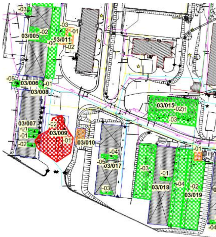
Abbildung 18: Fläche 03/009 (rot schraffiert) im Süden des Teilbereichs 5 (ehemalige Tankstelle; gekennzeichnete Altlast) 25
