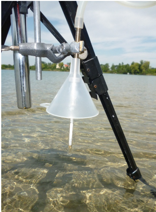
Foto Nr. 8: MP1 Badestrand, SVI-Tube (Probenröhrchen) mit Spritzschutz
