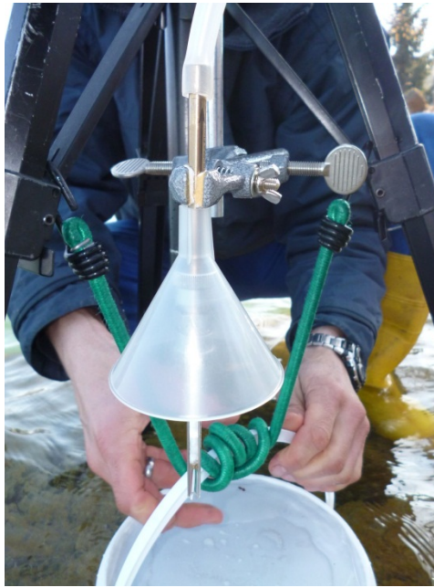
Foto Nr. 5: SVI-Tube (Probenröhrchen) mit Regen-/Spritzschutz
