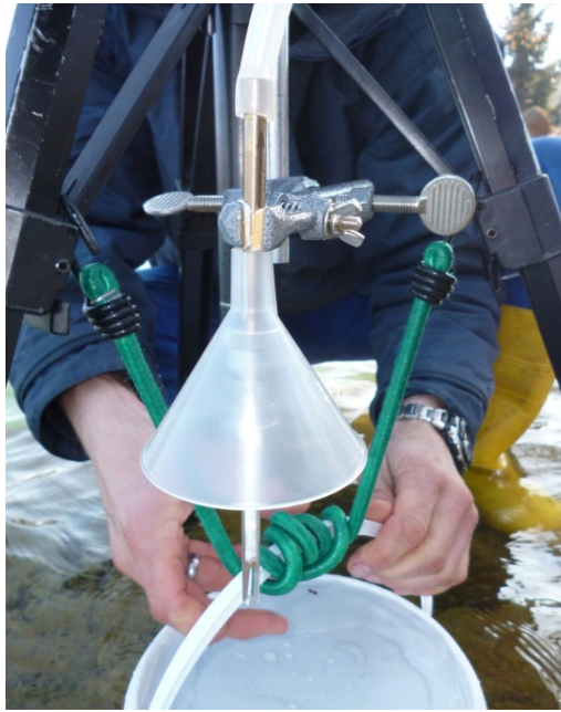
Foto Nr. 6: SVI-Tube (Probenröhrchen) mit Regen-/Spritzschutz
