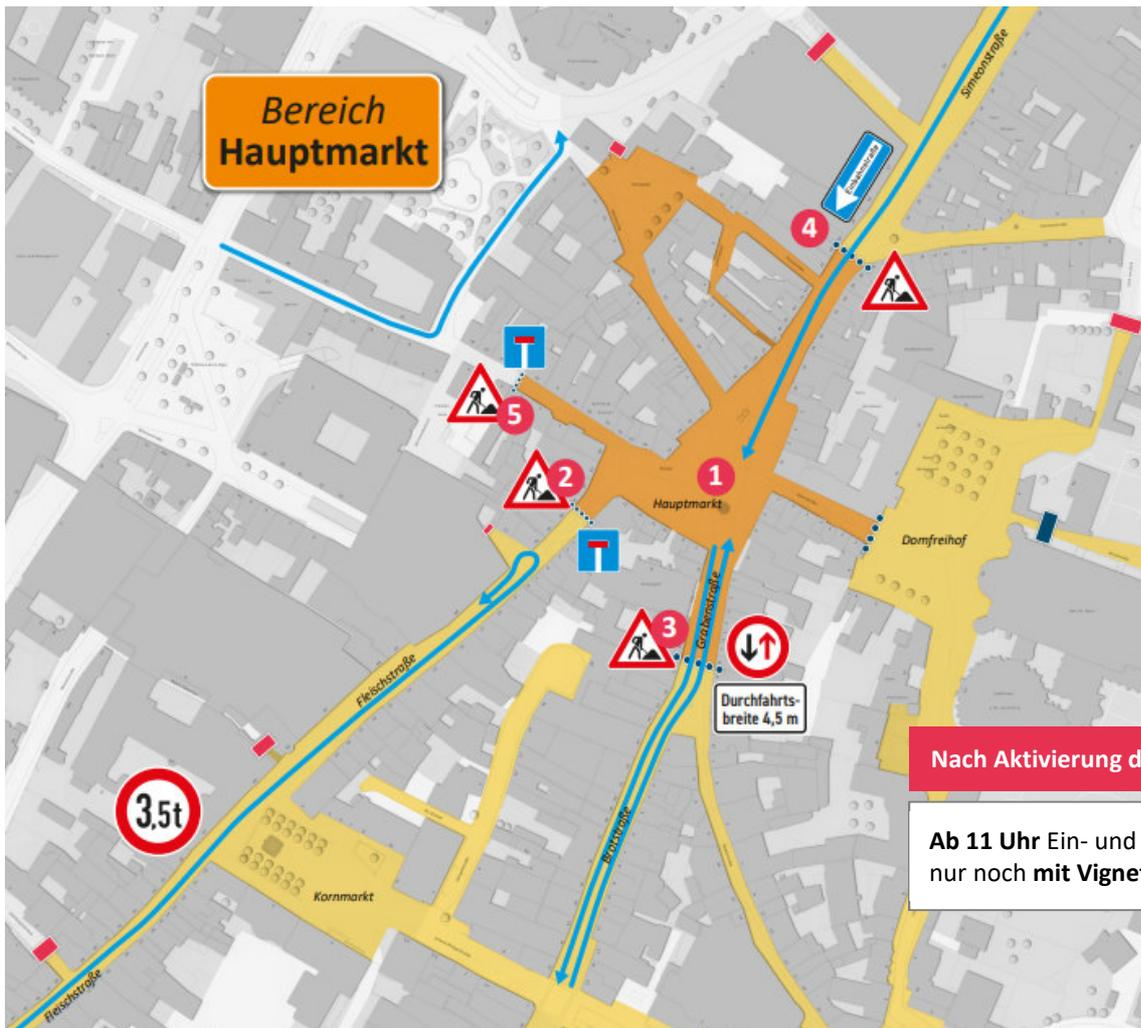
●●●● Versenkbare Poller    ■ Dauerhafte Blockade    ■ Demontierbare Blockade
