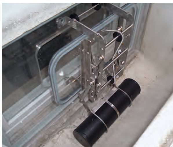
Automatisch schließende Vorsatzscheibe
