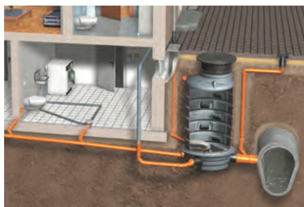
Rückstausicherung außerhalb des Gebäudes
