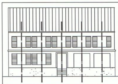
Beispiel für eine typische senkrechte und horizontale Anordnung der Fensteröffnungen
