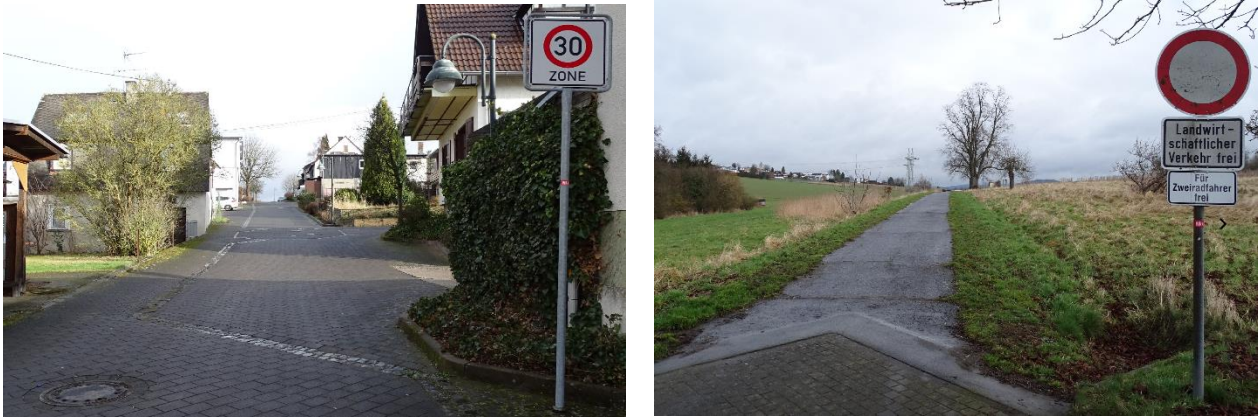
Abbildung 27: Gesicherte Radverkehrsführung: Mischverkehr innerhalb einer Tempo 30-Zone (links) und Führung auf einem Kfz-freien Weg (rechts)
