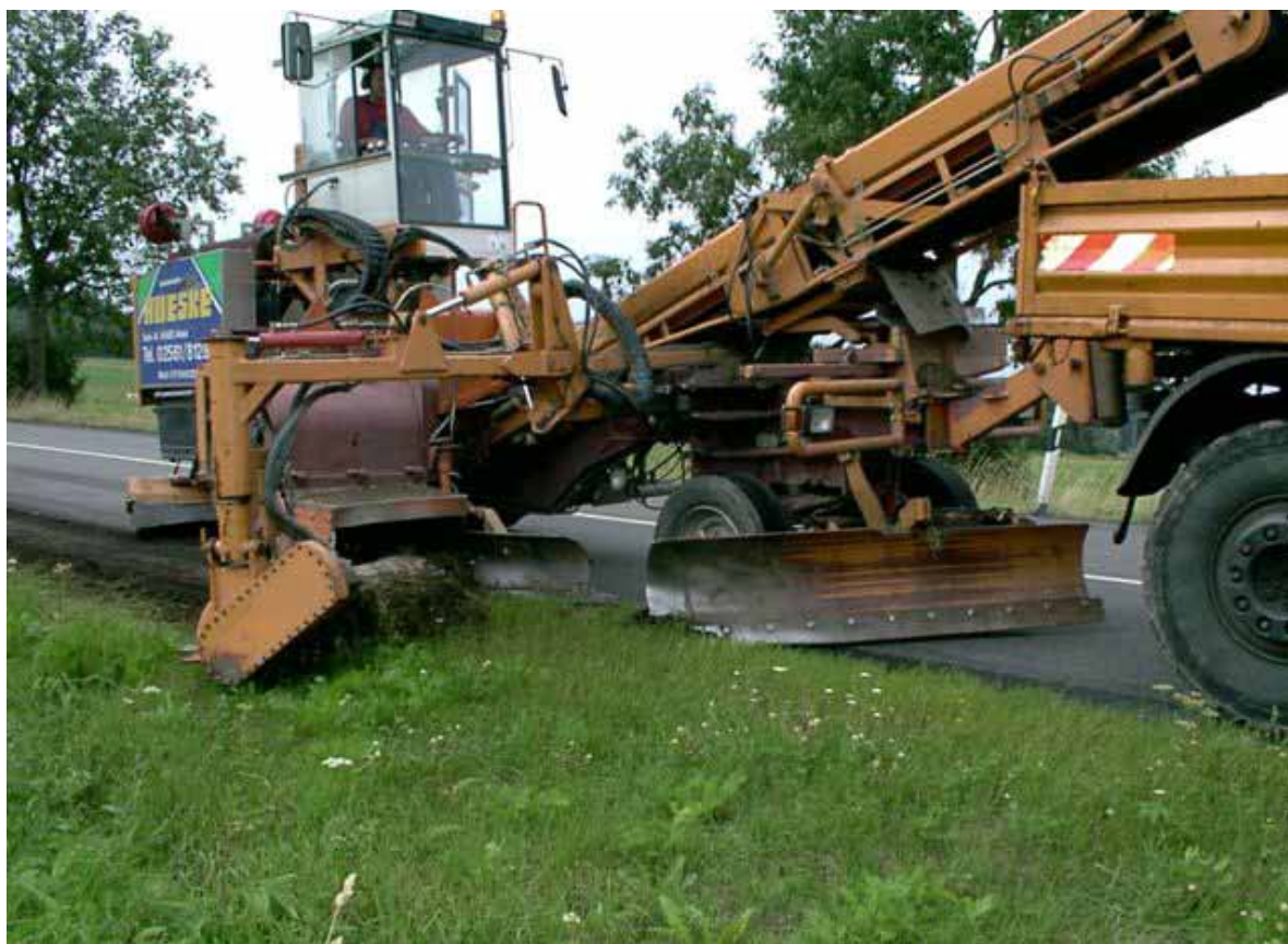
Abb. 22: Bankettschälmaschine mit Aufnahme des Schälgutes; Quelle: LBM
