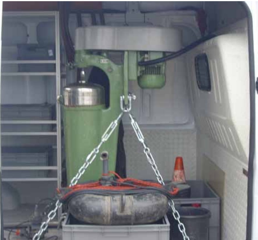
Abb. 48: Zentrifuge mit Spannkettens im neuen Fahrzeug
