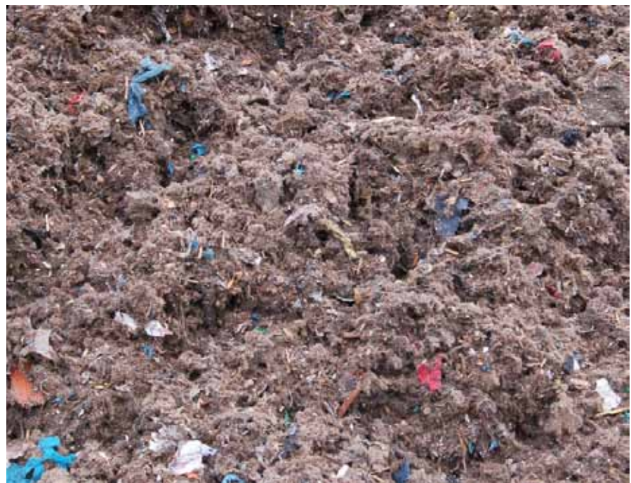
Abb. 27: Schredder-Feinfraktion nach Zerkleinerung und Wertstoffabtrennung
