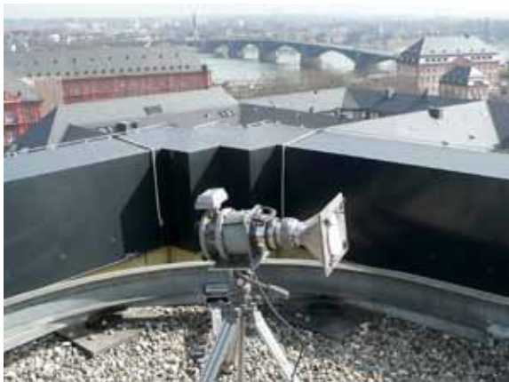
Abb. 13: Aerosammler auf dem Dach des Landesamtes
