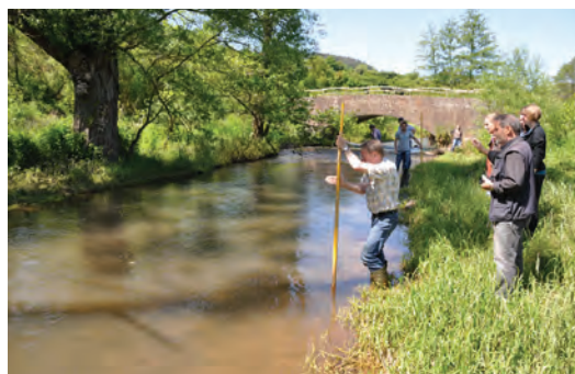
Abb. 31: Mehrere Durchgänge sind nötig, um die mittlere Fließgeschwindigkeit des Baches zu bestimmen.
