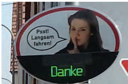
Abb. 14: Hinweisdisplay für die Lärmschutzmaßnahmen
