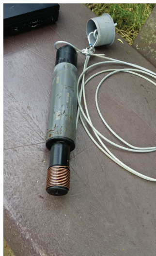
Abb. 36: HOBO-Logger mit Sicherungsdrahtseil und PVC Verschlusskappe
