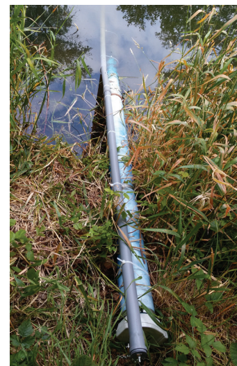
Abb. 37: Installation der Sonde im Gewässer in Führungsrohr aus PVC.
