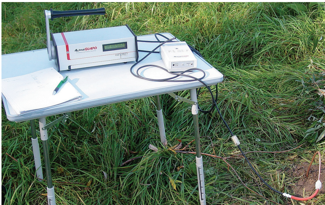
Abb. 12: Zeitauflösende Radonmessung im Gelände mit Bodensonde
