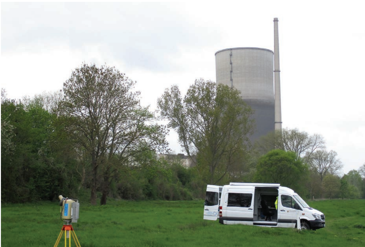
Abb. 6: Neues Strahlenmessfahrzeug des Referats 24 des Landesamtes im Einsatz bei einer in-situ-Gammaspektrometrie-Messung vor Mülheim-Kärlich
