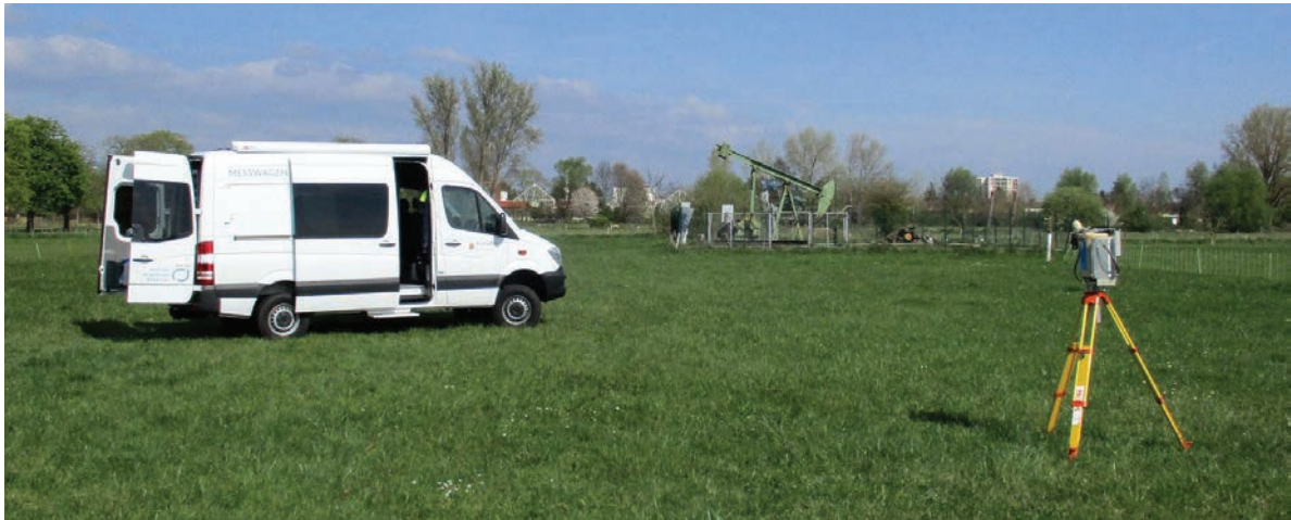
Abb. 5: Neues Strahlenmessfahrzeug des Referats 24 des Landesamtes bei einer in-situ-Gammaspektrometrie-Messung nach Strahlenschutzvorsorgegesetz
