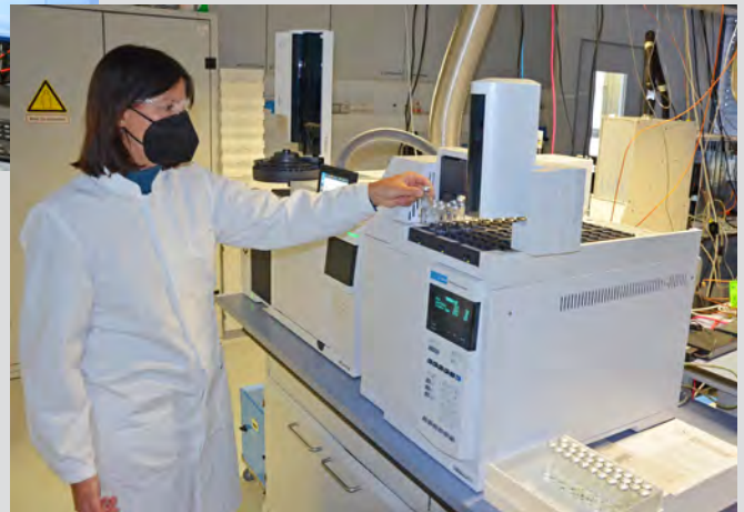
Leichtflüchtige organische Verbindungen in Wasser werden mit dem Gaschromatograph-Massenspektrometer-Kopplung mit Headspace-Funktion bestimmt.
