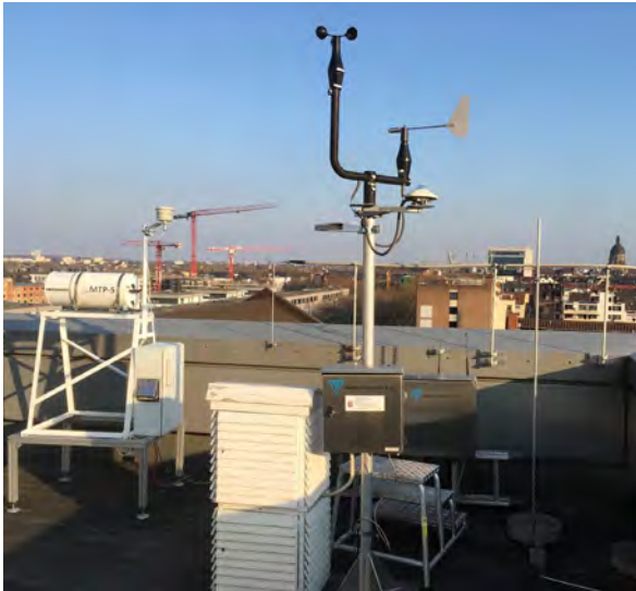
Radiometer auf dem Dach des Umweltlabors in Mainz
