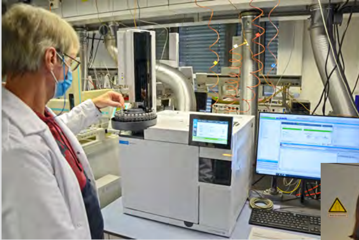
Der Gaschromatograph mit Flammenionisationsdetektor dient der Bestimmung des Kohlenwasserstoffindex in Wasserproben.
