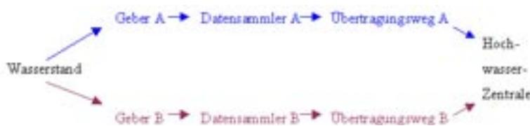
Abb. 1: Redundante Messwerterfassung und -übertragung an Pegeln
