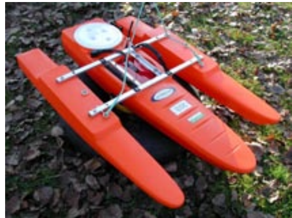
Abb. 2: Trimaran mit ADCP-Sonde
