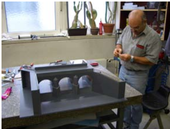
Abb. 63: Bau der Bauwerksmodelle als Fertigmodule
