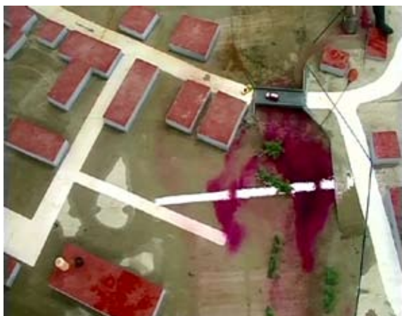
Abb. 71: Strömungssituation unterstrom der Brücke Lauerstraße im Ist-Zustand
