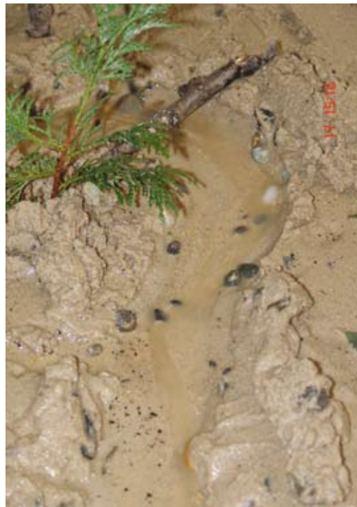
Abb. 90: Dem Bach ins Bett zu schauen... ...ist auch am Modell möglich: Sohlsubstrat sortiert sich, Prall- und Gleithänge entstehen, die Tiefenrinne ist deutlich zu sehen und Störsteine lassen den Stromstrich pendeln, ... wie in der realen Natur.
