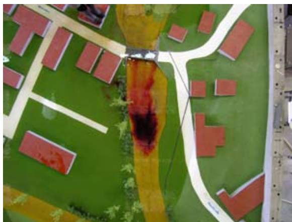
Abb. 72: Strömungssituation unterstrom der Brücke Lauerstraße im Ausführungsvorschlag
