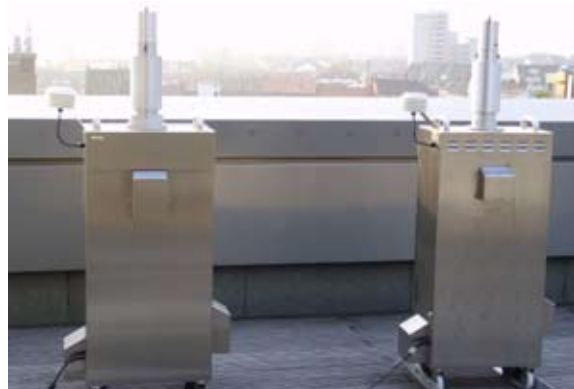
Abb. 52: Probensammler vom Typ SEQ 47/50 für die Probenahme von PM10-Feinstaub
