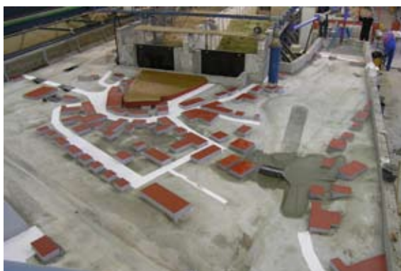
Abb. 64: Das physikalische Modell vor der Kalibrierung
