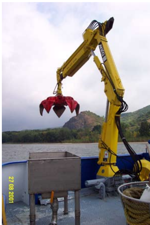
Abb. 102: Polypgreifer der „MS Burgund“ zur Beprobung der Rheinsohle.
