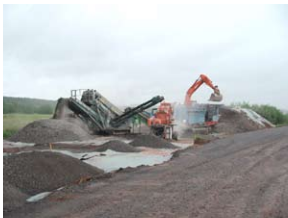
Abb. 33: Aufbereitung von Straßenaufbruch vor Ort
