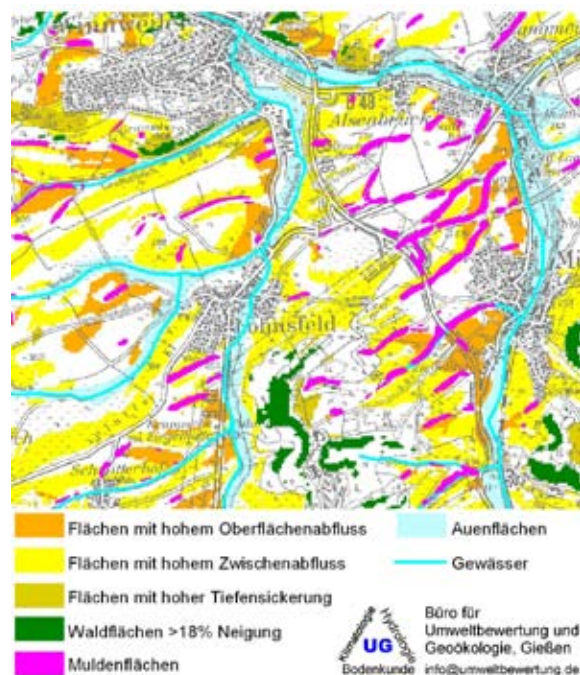
Abb. 115: Hochwasserrückhalt auf der Fläche
