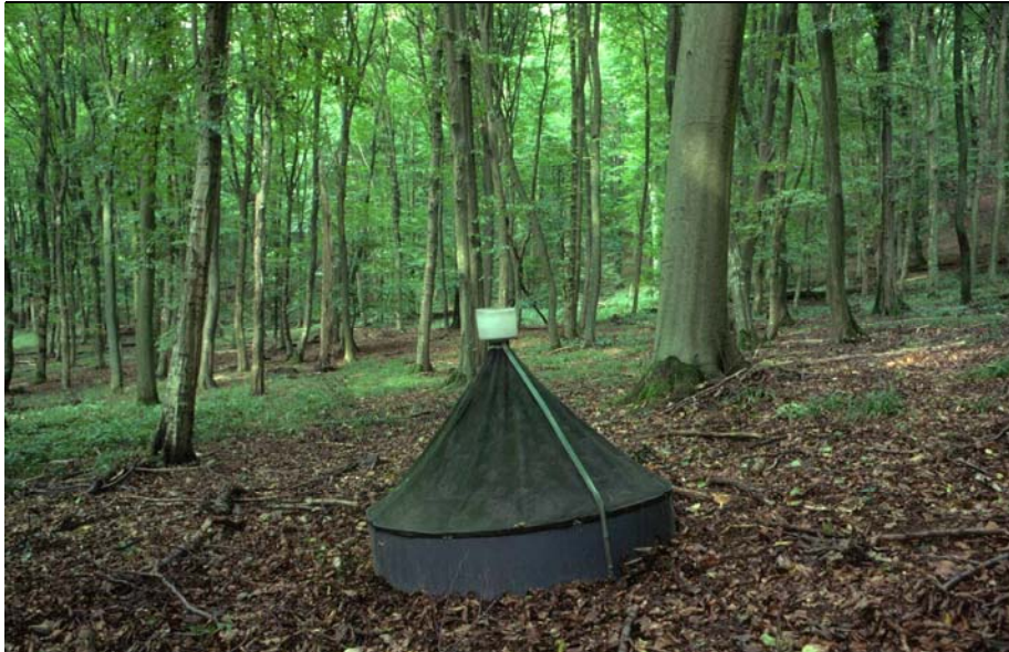
Bodenphotoeklektor zur Erforschung der epedaphischen Fauna
