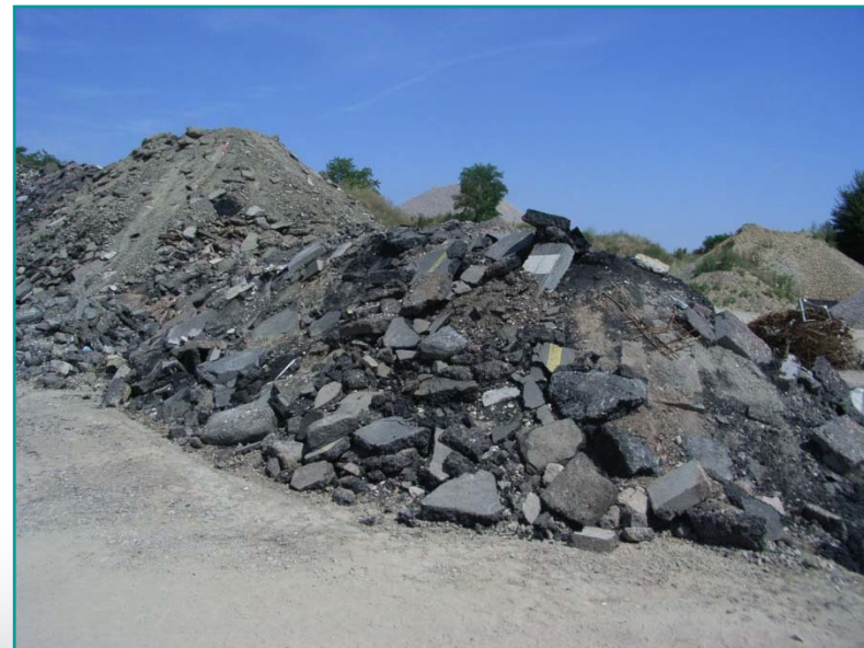
Sortenreiner Asphalt aus dem Rückbau in Schollen
