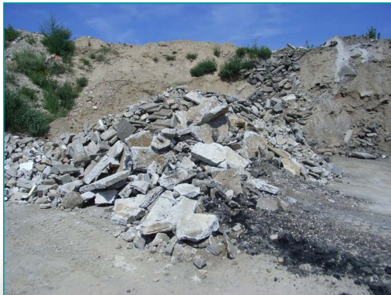
Sortenreiner Beton aus dem Rückbau
