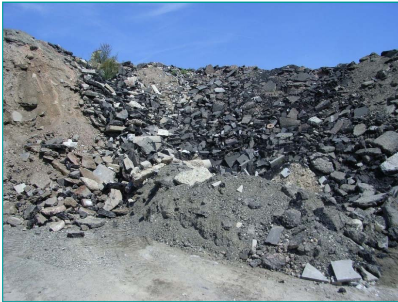
Vorher: Straßenaufbruch Asphalt Schollen
