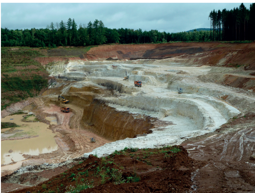
Abb. 5.9: Tertiärer Ton in der Tongrube Meudt. Die in verschiedenen Varietäten vorkommenden tertiären Tone bilden einen mehrere Zehnermeter mächtigen Grundwasserergleiter (Foto: A. Wehinger). TK 25 Blatt 5513 Meudt, südöstlich Meudt; UTM32-Koordinaten E: 423276, N: 5592713.
