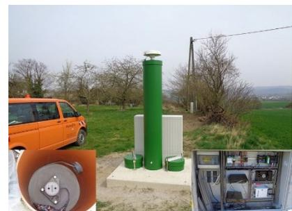
Multisensorstation Probstei in Buchholz (in den beiden Rohren links und rechts befinden sich die Neigungsmesser / Elektrokasten mit nötiger Technik).
