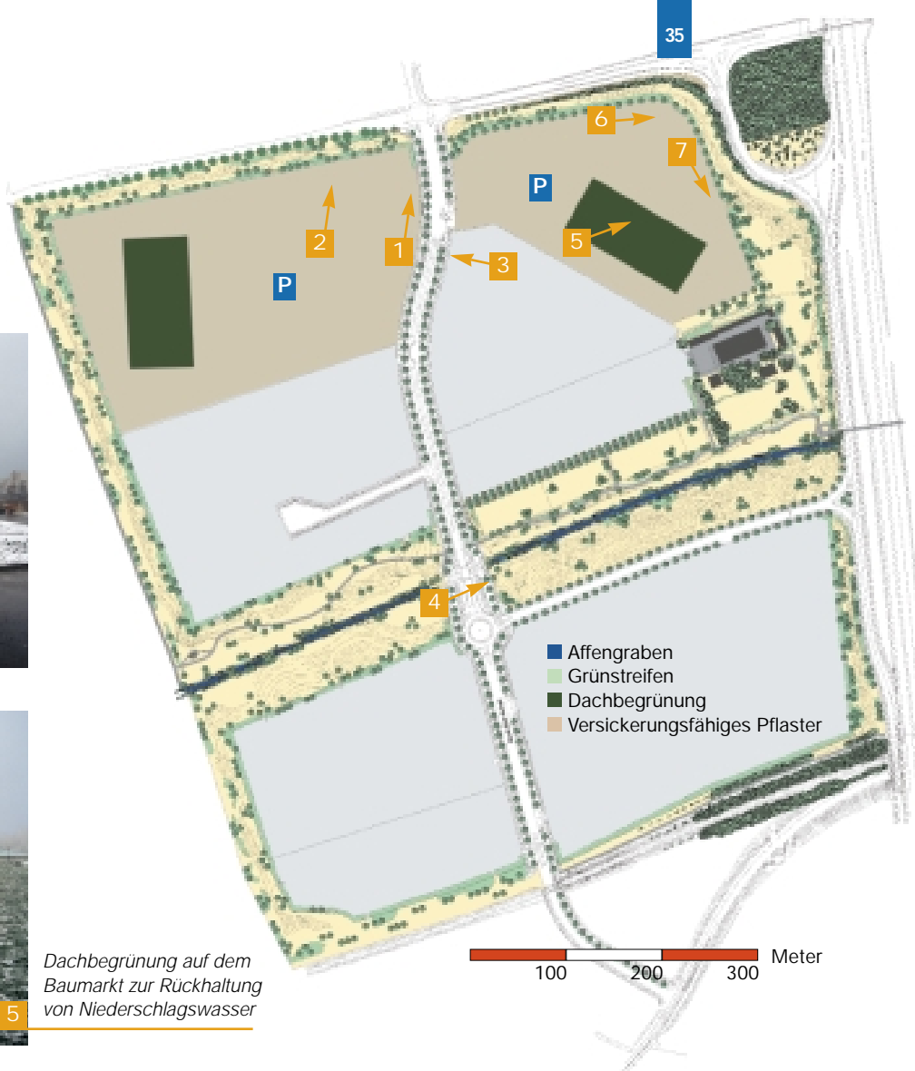
Versickerungsgraben um das Baummarkt-gelände. Der Graben liegt je zur Hälfte auf privatem und öffentlichem Boden.
