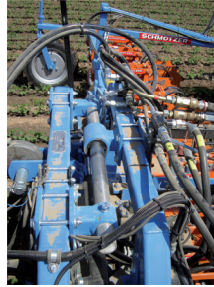
Abb.6: Verschiebbare Hackrahmen und automatische Steuerung ermöglichen mit modernen Hackgeräten höhere Flächenleistungen.
