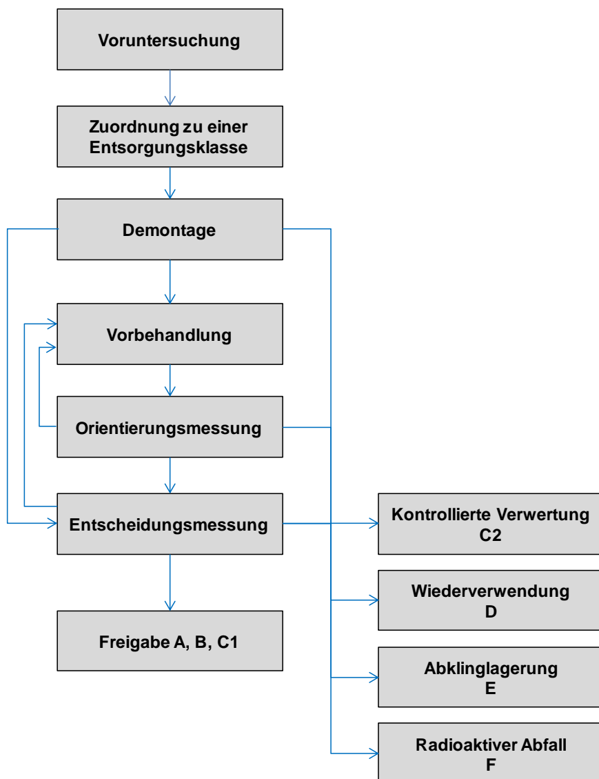
Abbildung 5-3: Vorgehensweise bei der Bearbeitung radioaktiver Reststoffe aus dem Kontrollbereich
