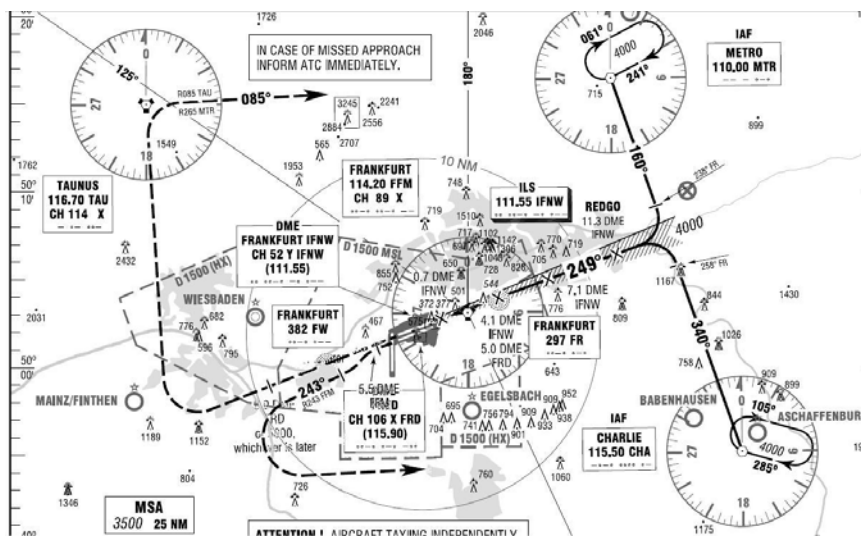
Abbildung 16 Eine einzige Abbildung zeigt die kombinierten Fehlanflugverfahren auf RWY 25R und 25L. Quelle: deutsches Luftfahrthandbuch
