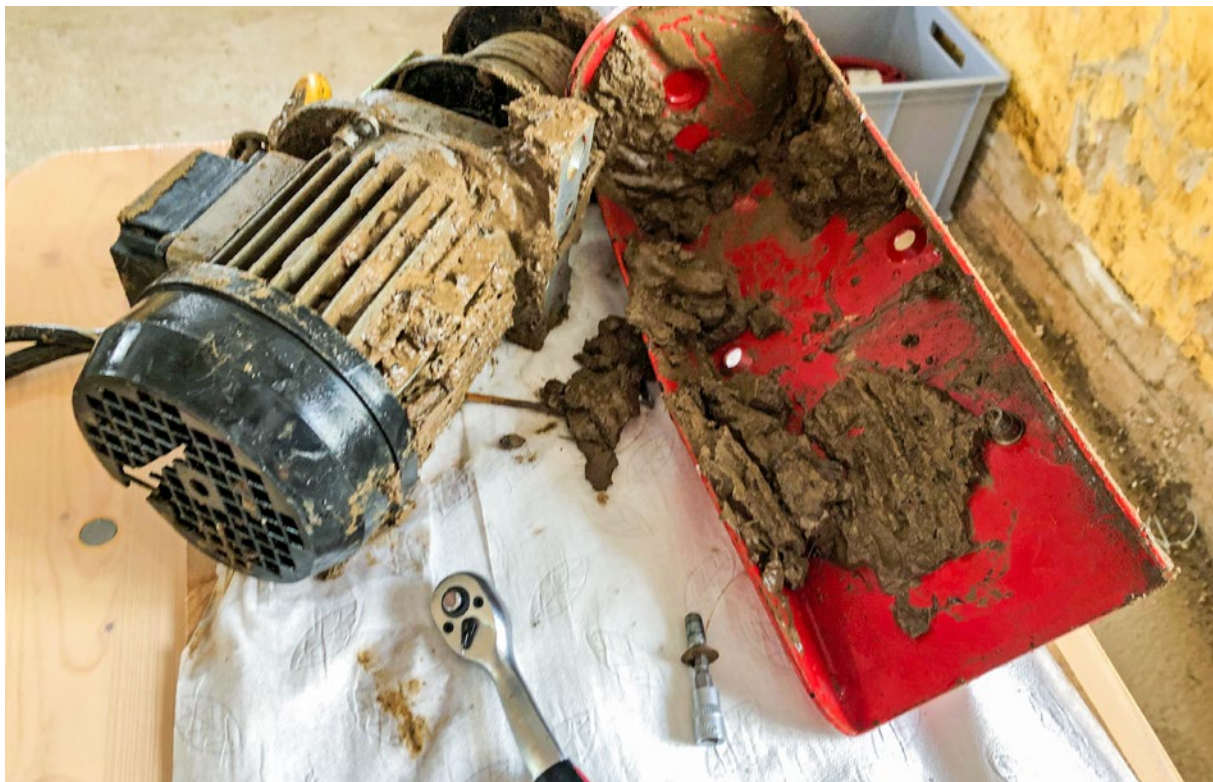
Eine verschlammte Seilwinde nach der Öffnung des Gehäuses. (Foto: Hochschule Koblenz/Theisen)
