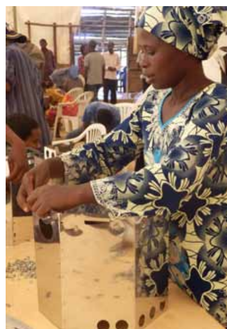
Trainierte Bewohnerin des Kiziba Camps beim Zusammenbau des Save80 Ofens
