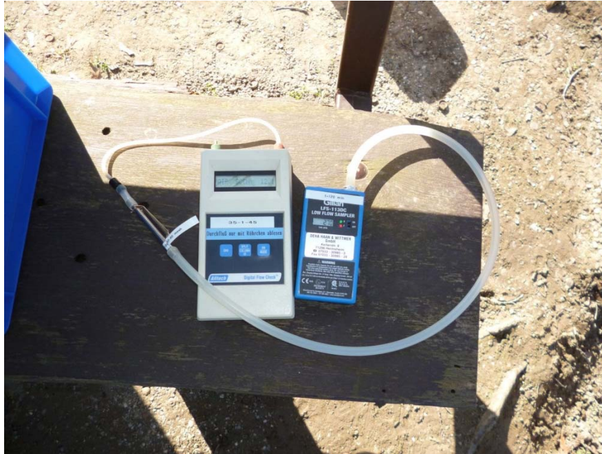
Foto Nr. 1: Prüfung des Volumenstromes der Probenahmepumpen (Vor- und Nach der Probenahme)
