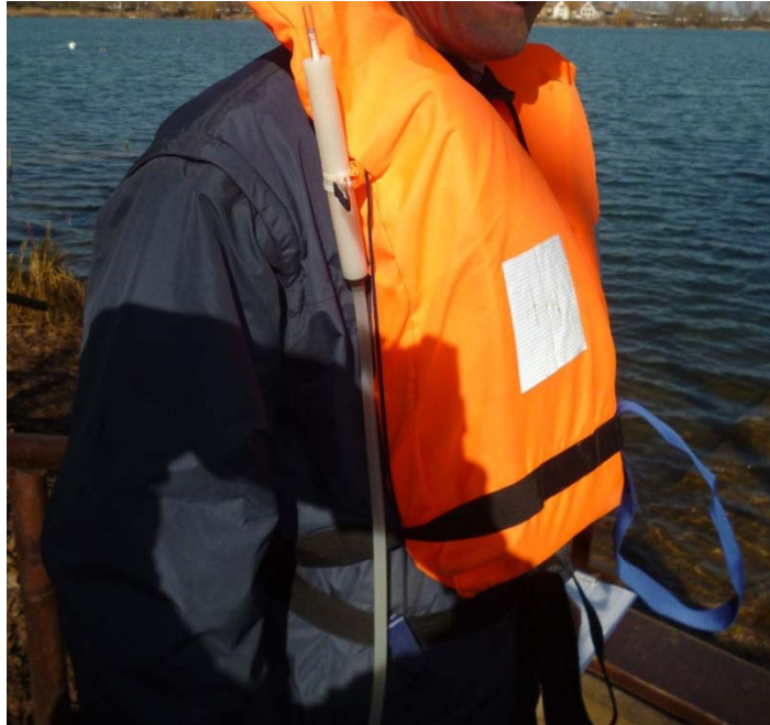
Foto Nr. 11: Probenahmeverrichtung für Bootsbefahrung (PS3 Bootsfahrt)
