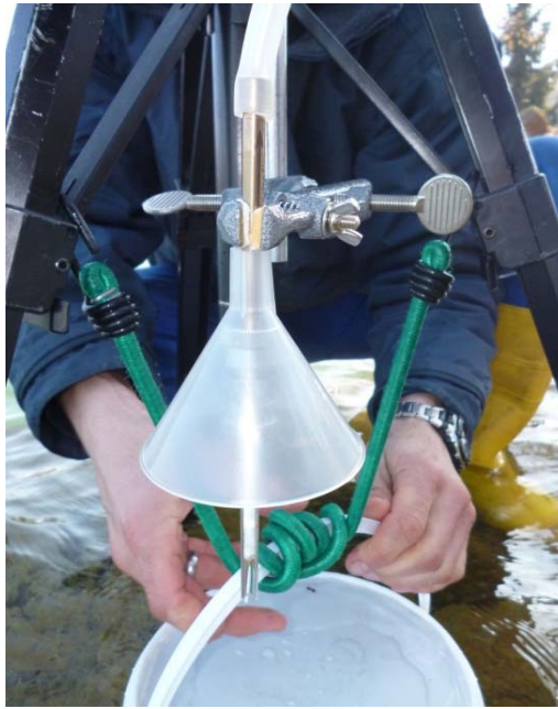
Foto Nr. 6: SVI-Tube (Probenröhrchen) mit Regen-/Spritzschutz
