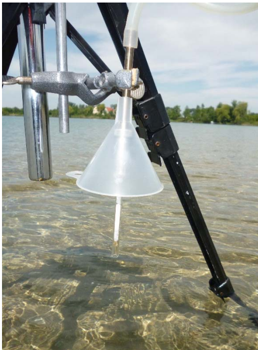
Foto Nr. 9: MP1 Badestrand, SVI-Tube (Probenröhrchen) mit Spritzschutz
